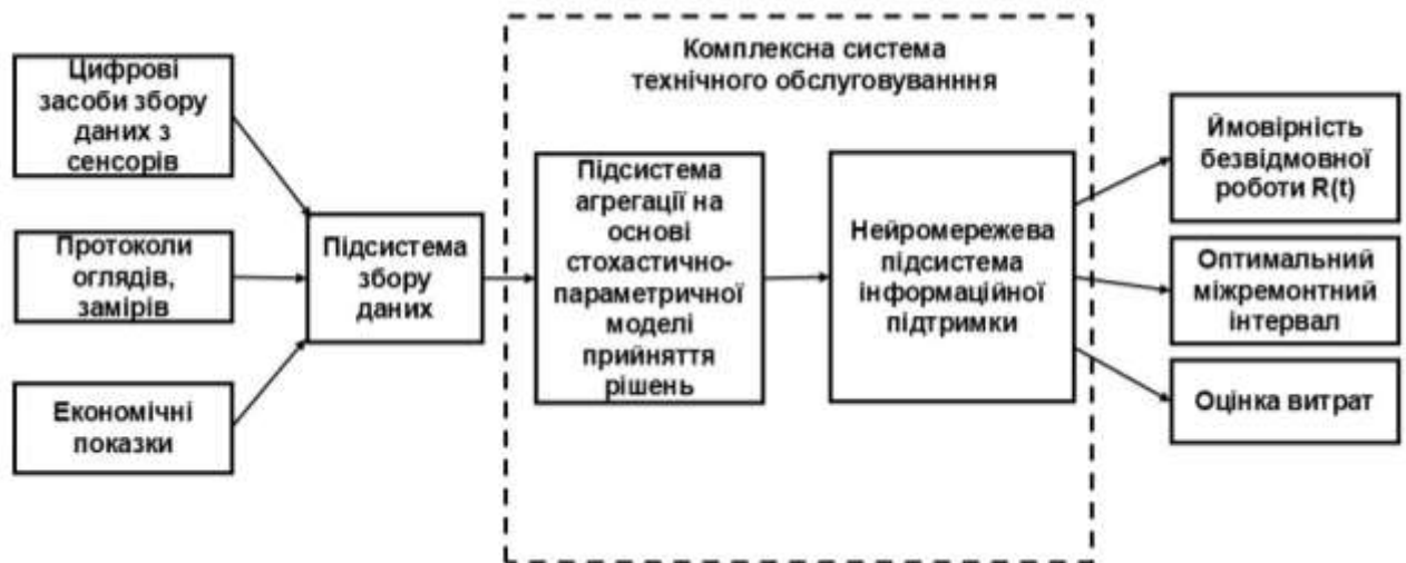
Рисунок 4.1 - Структура комп'ютерної системи моніторингу та прогнозування ремонтів залізничного рухомого складу на основі стохастично-параметричної моделі
