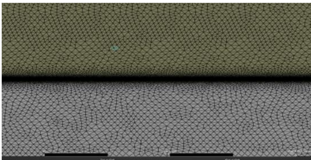
Рисунок 4.4 – Градієнтне згущення елементів уздовж ділянки (bias-дискретизація), навколо стовбура свердловини
