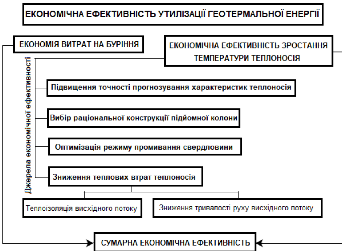
Рисунок 5.11 – Структура розрахункового алгоритму визначення економічної ефективності вилучення геотермальної енергії нафтогазових свердловин
