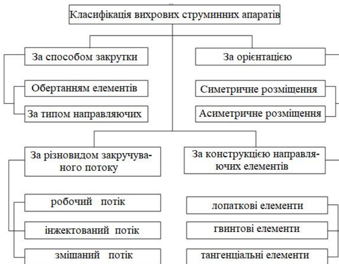
Рисунок 1.5 – Схема класифікації вихрових свердловинних ежекційних систем
