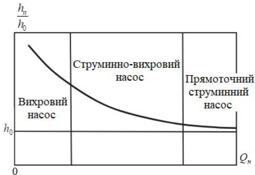
Рисунок 2.37 – Області використання вихрових ежекторів та прямоточних ежекційних систем
