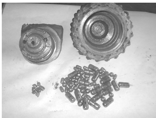
Рисунок 3 – Розколювання, зношування тіл кочення секції відпрацьованого долота
