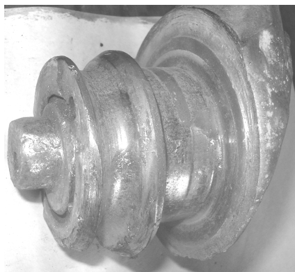
Рисунок 2 – Характер зношування цапфи долота в навантаженій зоні
