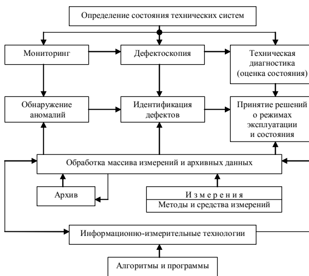
Рис. 1. Алгоритм определения состояния технических систем
