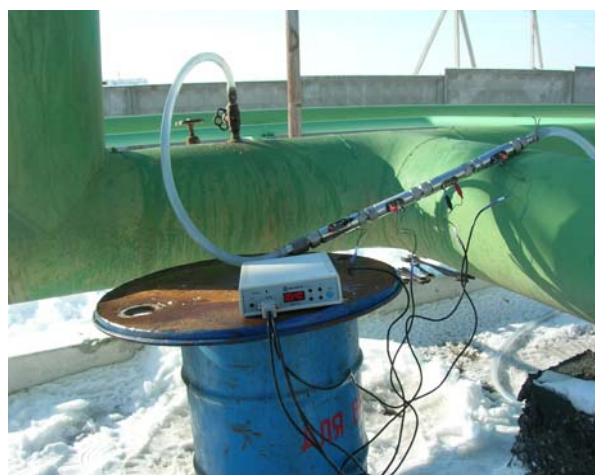
Рисунок 4 – Дослідження корозійної агресивності середовища за допомогою пілотної установки "Монікор-стенд"
