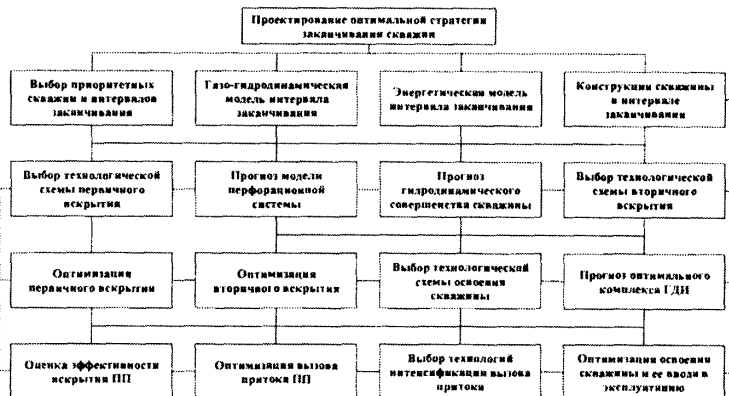
Рис. 7. Функциональная схема системы оптимального проектирования заканчивания и освоения скважин.
