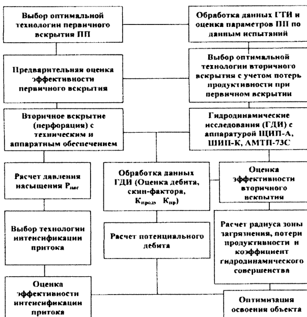
Рис. 8. Функциональная схема оптимизированного заканчивания скважин с обеспечением управляемого вскрытия ПП.
