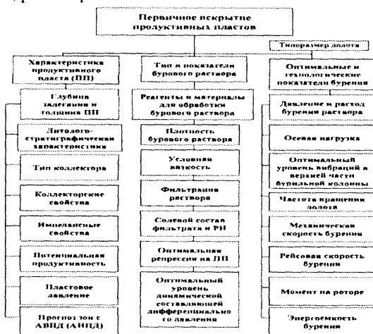
Рис. 5. Функциональная схема проектирования оптимизированной технологии первичного вскрытия ПП.
