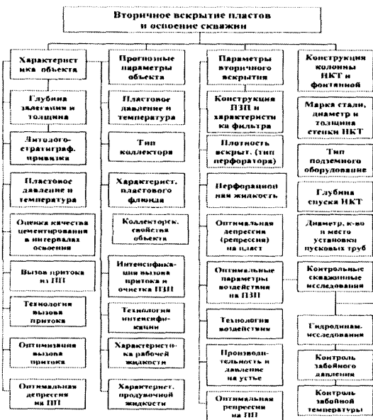
Рис. 6. Функциональная схема проектирования оптимизированной технологии вторичного вскрытия ПП и освоения скважин.
