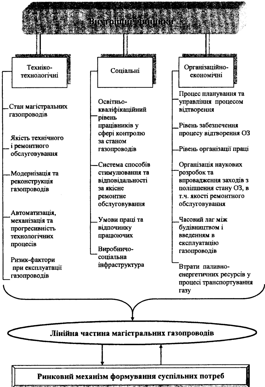
Рис. 2 Класифікація внутрішніх чинників впливу на процес відтворення лінійної частини магістральних газопроводів
