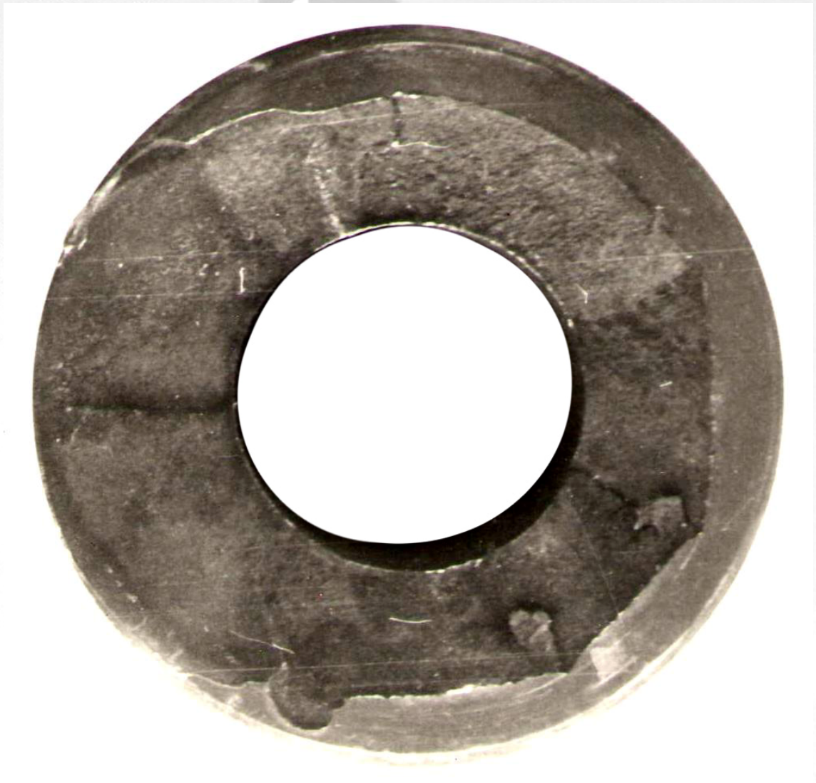
Рисунок 2.19 – Злам замка бурильної труби діаметром 89 мм французького виробництва. Руйнація відбулась у свердловині надлишкового моменту згвинчування. Крихке руйнування відбулося по декількох площинах. Є явно вираженні сліди пластичної деформації, структура зламу крупнозерниста
