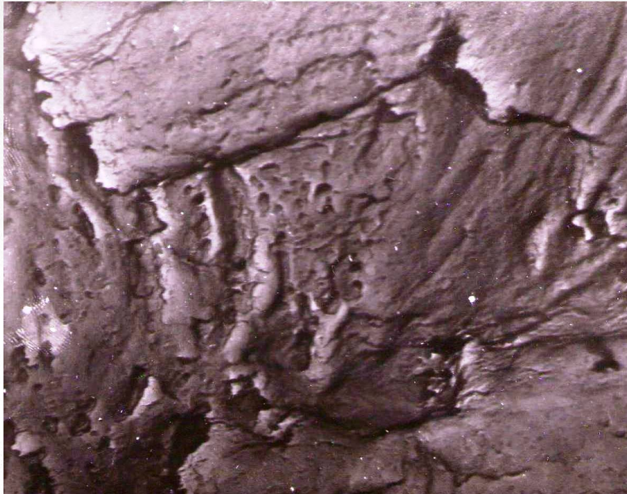
Рисунок 2. 2 – Мікрофрактограма корозійної втоми зламу різьби 3-42 в стані поставки ферит-перлітної структури. Поряд зі звивистою структурою спостерігаються скольні зони
