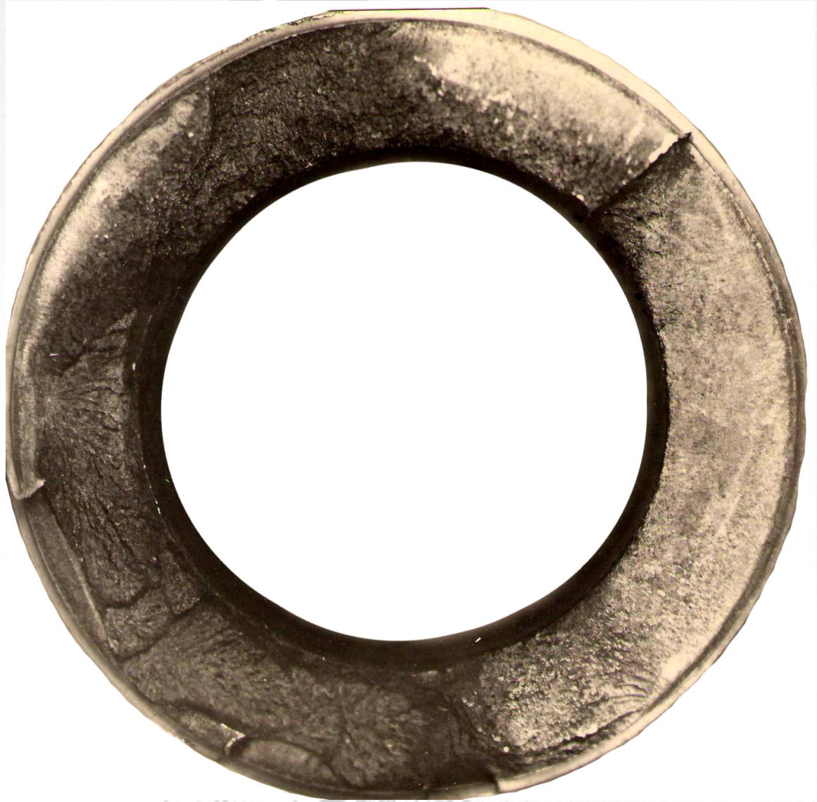
Рисунок 2.24 – Злам бурильної труби діаметром 114×10 мм групи міцності «Е» на стенді УКІ-7 по висадженій частині. В нижній правій частині явно виражені дві зони зародження втомних тріщин. У верхній частині розміщена зона розповсюдження тріщин. У лівій частині спостерігається зона доламу, яка характеризується гладкою поверхнею. Зона доламу складає 35 %
