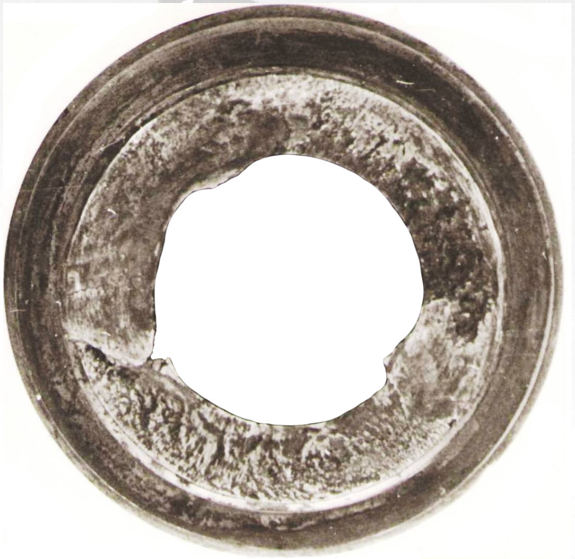
Рисунок 2.18 – Злам замка труби діаметром 89 мм французького виробництва, який зруйнувався у свердловині Шевченково-1 внаслідок надмірного моменту згвинчування. Крихке руйнування виникло по декількох площинах. Структура зламу крупнозерниста. Є чітко вираженні сліди пластичної деформації
