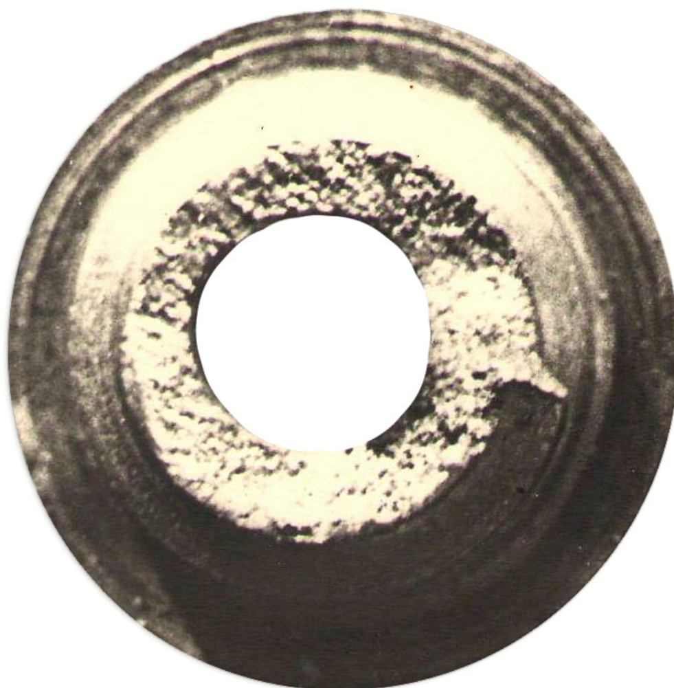
Рисунок 2.6 – Крупнозернистий злам з'єднання 3-26 після випробувань на повітрі на стенді ИМА-30. Сталь групи міцності «Д». Надзвичайно крупнозерниста структура викликана перегрівом матеріалу при гартуванні
