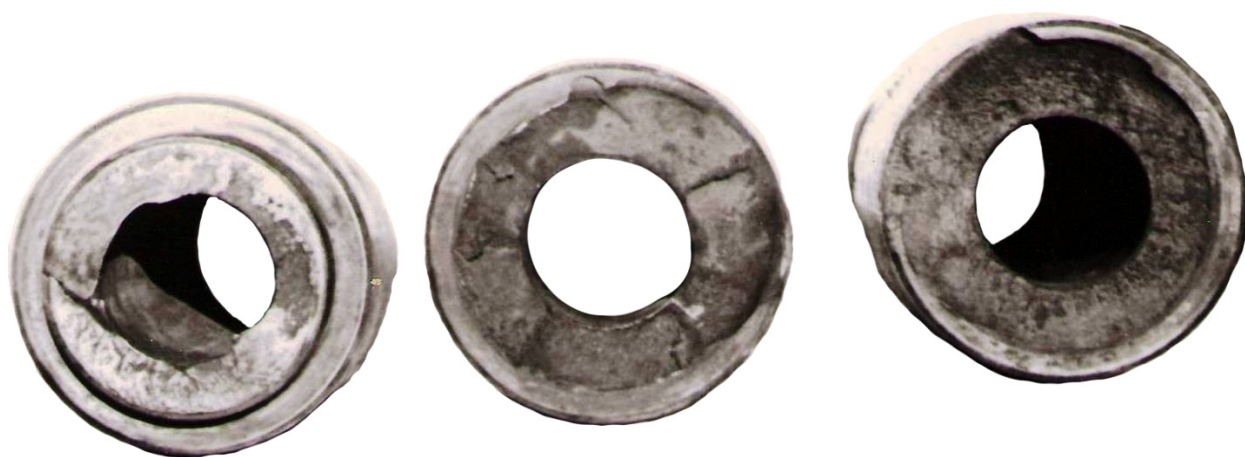
Рисунок 2.17 – Злами замків діаметром 89 мм французького виробництва, котрі зруйнувались у свердловині «Шевченково-1» внаслідок надмірного моменту згвинчування. Крихке руйнування виникло у декількох площинах. Структура зламу крупнозерниста. Є явно вираженні сліди пластичної деформації
