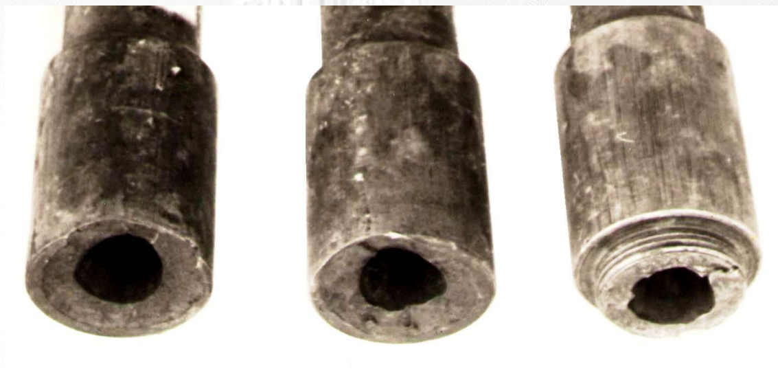
Рисунок 2.16 – Злами бурильних замків труб діаметром 89мм французького виробництва, зруйнованих у свердловині внаслідок надмірного моменту згвинчування. Крихке руйнування виникло по декількох площинах. Наявні чітко виражені сліди пластичної деформації
