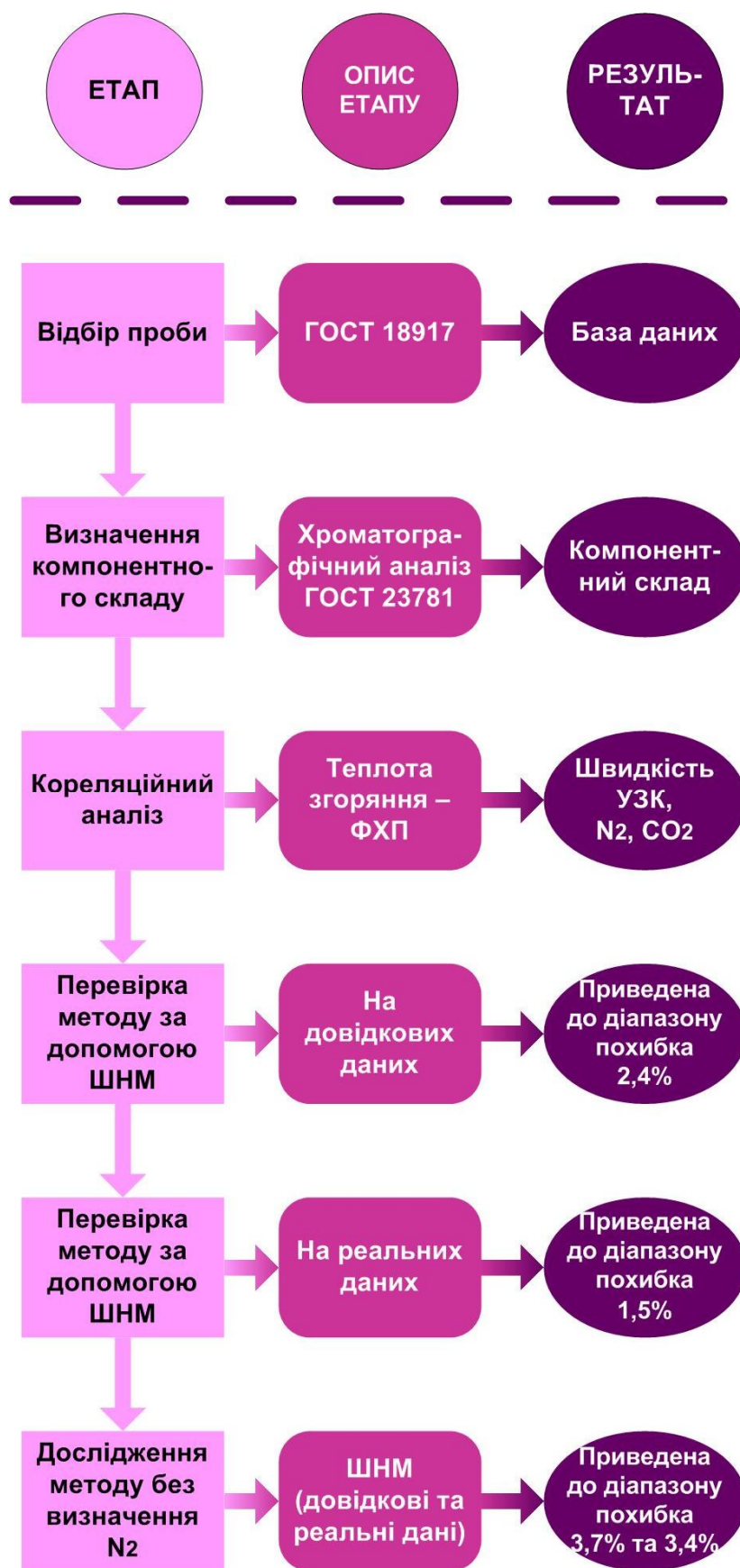
Рисунок 1 – Схема процесу дослідження нового методу визначення теплоти згоряння природного газу
