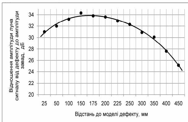
Рисунок 5 – Експериментальна залежність амплітуди луно сигналу від дефекту відносно амплітуди завад від відстані між ЕМАП і відбивачем
