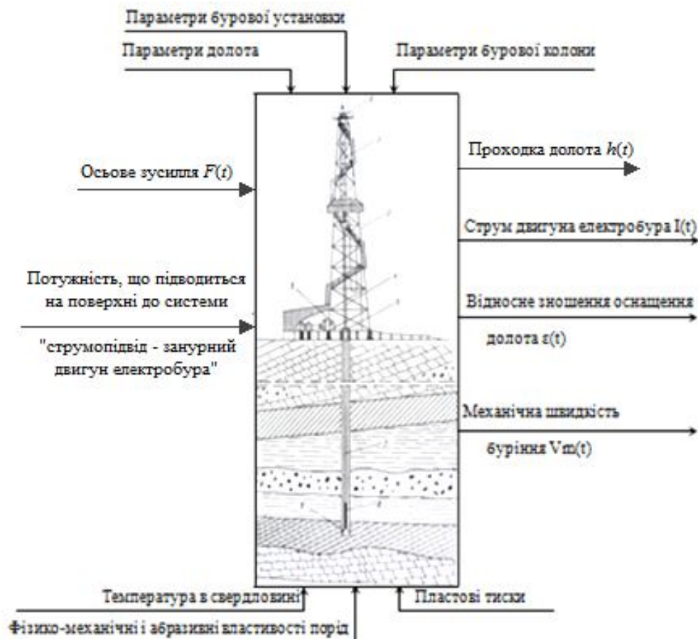
Рисунок 1 – Структурна схема процесу буріння свердловин електробуром
