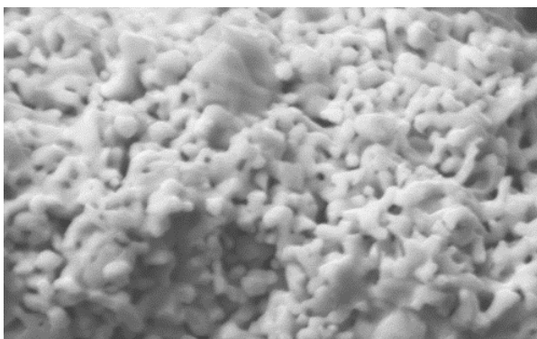
Рисунок 3 – Фрактограма злому пористого каркасу NbC (×2000)
