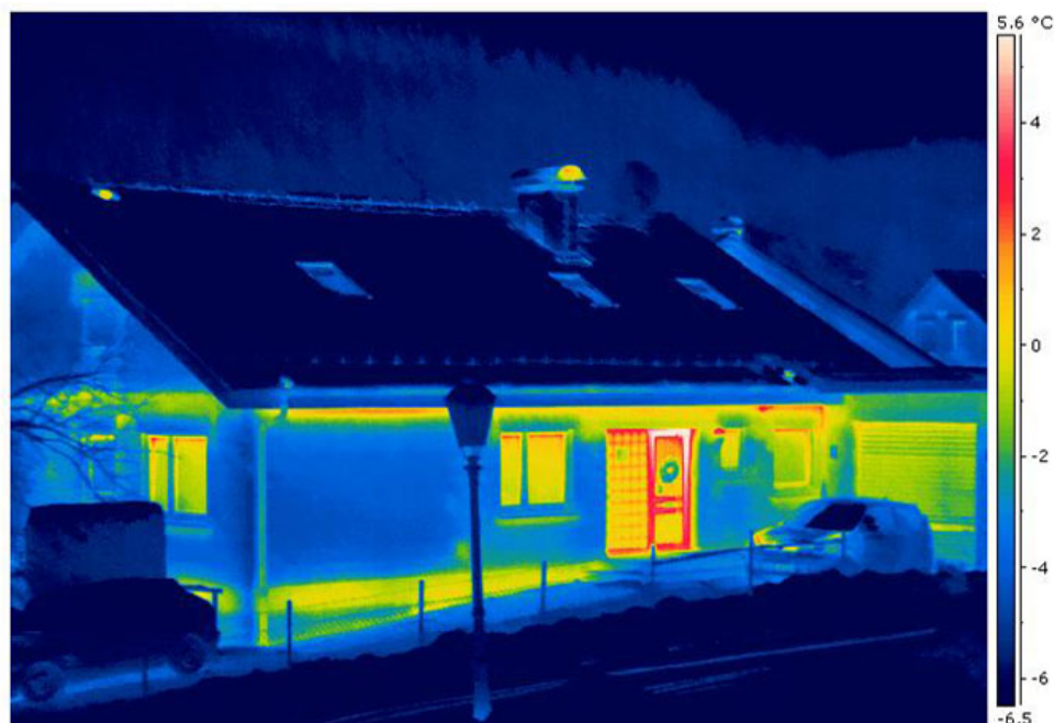
Рисунок 3 – Тепловізійна зйомка одноповерхового будинку
