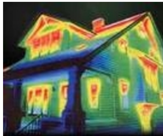
Рисунок 2 – Фотографія дослідження тепловтрат типового будинку тепловізором
