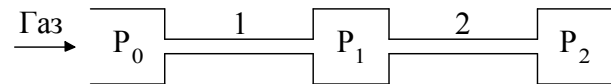
Рис. 3. Пневматична камера постійного об'єму з ламінарними дросельними елементами на її вході та виході.
