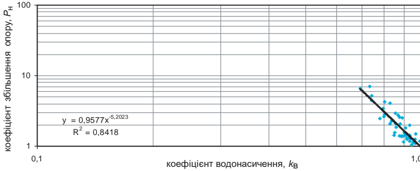
Рис. 31. Кореляційна залежність між коефіцієнтом водонасиченості ( k_v ) та коефіцієнтом збільшення опору ( P_n ) для пісковиків виражається емпіричною формулою
