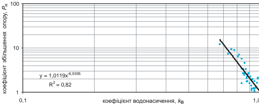
Рис. 32. Кореляційна залежність між коефіцієнтом водонасиченості ( k_v ) та коефіцієнтом збільшення опору ( P_n ) для алеволітів виражається емпіричною формулою
