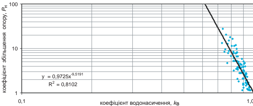
Рис. 33. Кореляційна залежність між коефіцієнтом водонасиченості ( k_v ) та коефіцієнтом збільшення опору ( P_n ) для аргілітів і сланців виражається емпіричною формулою
