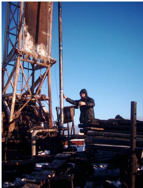
Рисунок 3 – Обработка нефтяной скважины электроразрядным погружным устройством
