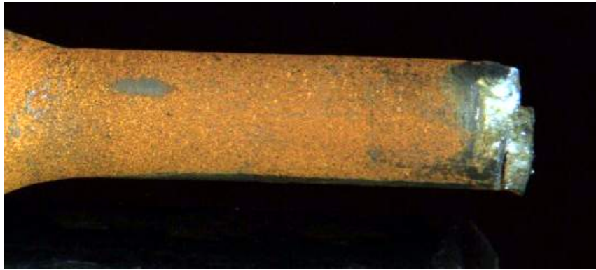
Рисунок 3 – Зруйнований зразок, покритий продуктами корозії ( \sigma_a = 310 МПа, N = 25732 цикли)
