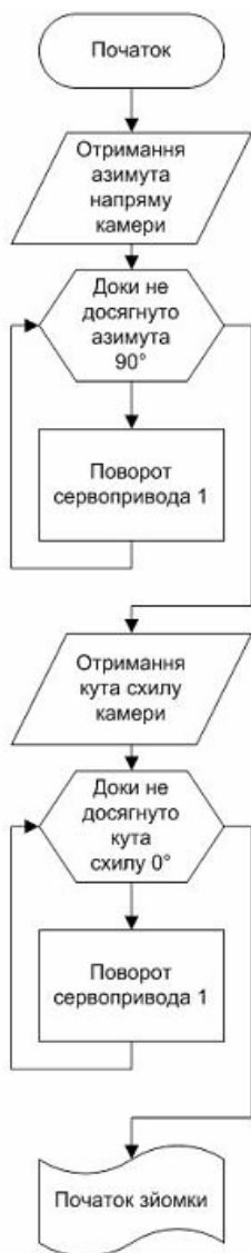
Рисунок 2 – Алгоритм функціонування програмного забезпечення мікропроцесорної системи в режимі позиціонування
