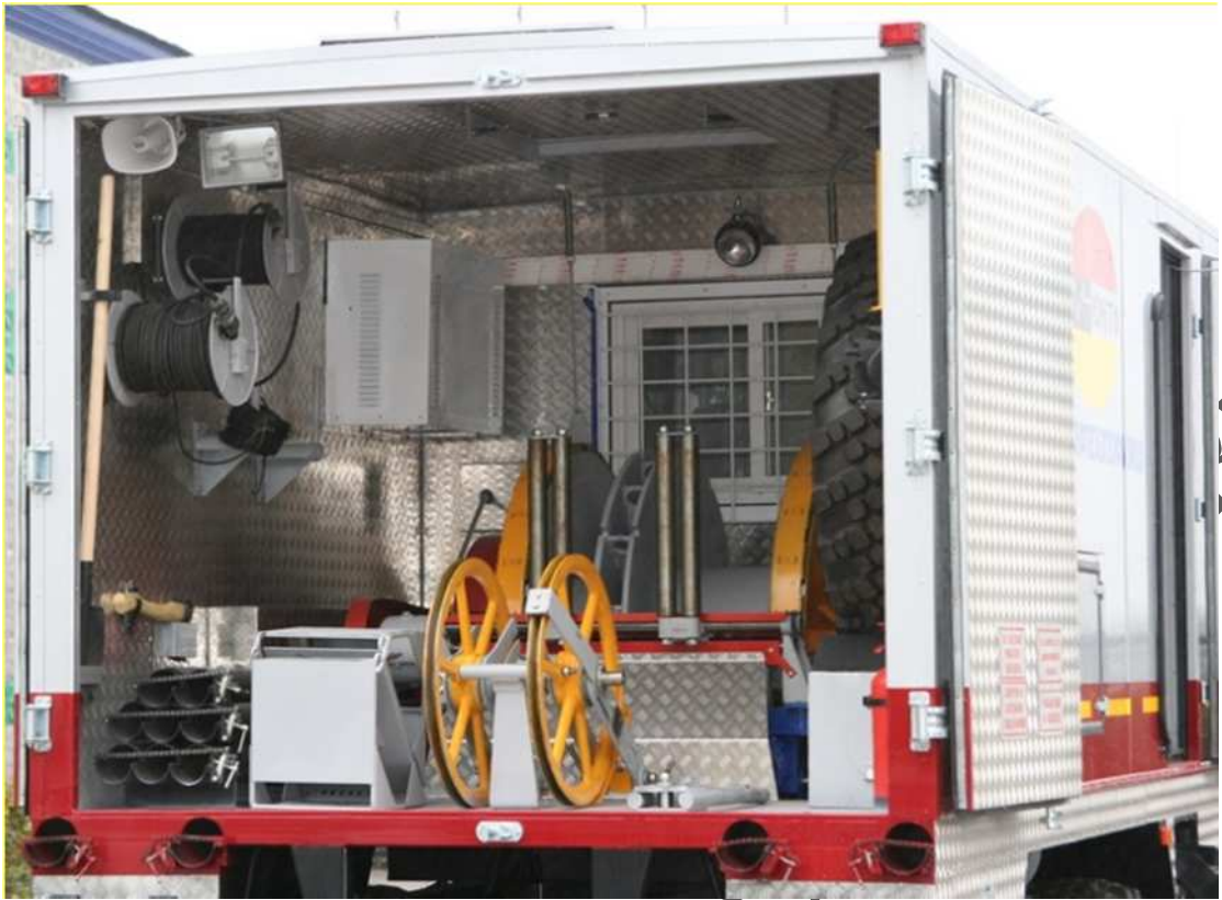
Рисунок 1.4 – Підйомник для спуску і підйому глибинних манометрів
