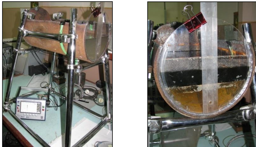
Рисунок 3.14 – Експериментальна установка для моделювання двофазних скупчень рідини
