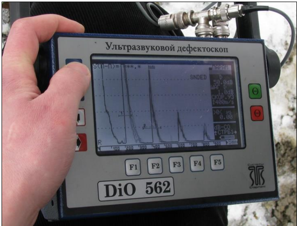
Рисунок 4.2 – Екран дефектоскопу, при вимірюванні рівня скупчень в порожнині трубопроводу
