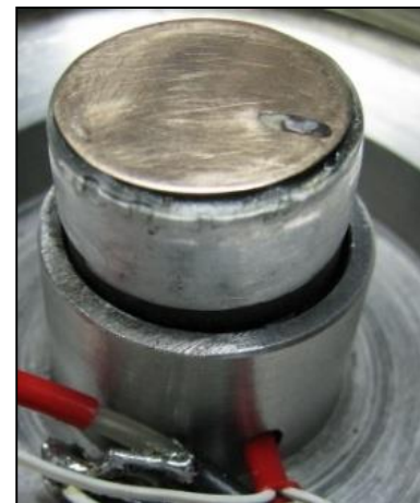
Рисунок 3.10 – Ультразвуковий п'єзоелектричний перетворювач акустичного блоку
