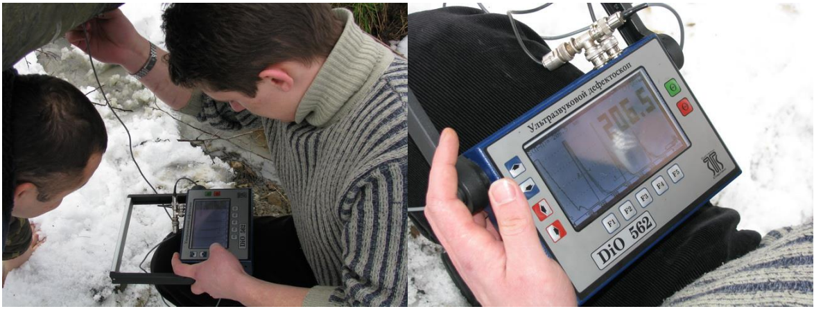
Рисунок 4.4 – Проведення вимірювання рівня рідини в порожнині діючого газопроводу «Пасічна-Тисмениця»
