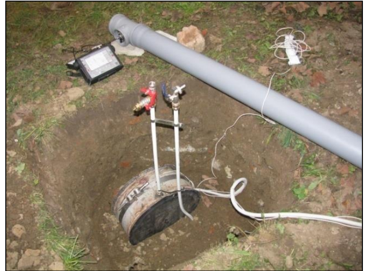
Рисунок 3.12 – Проведення чергового вимірювання рівня рідини в порожнині експериментальної секції (червень 2013 року)
