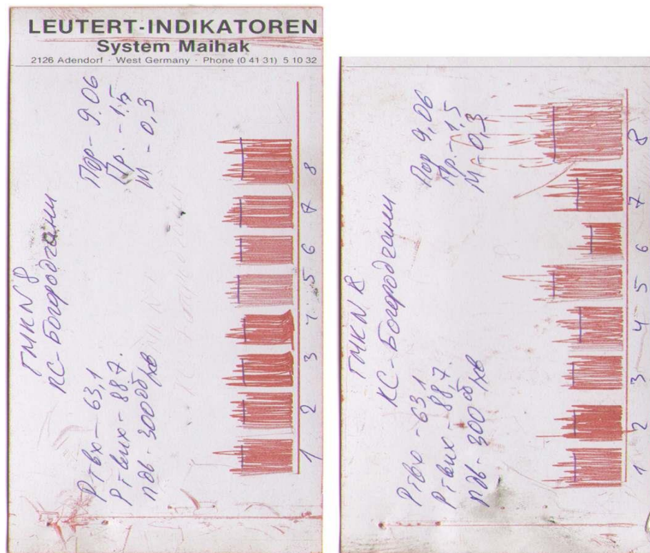
Рисунок 2.10 – Приклад індикаторних діаграм силових циліндрів газомотокомпресора МК-8 ст.№8 компресорної станції Богородчанського ПСТ
