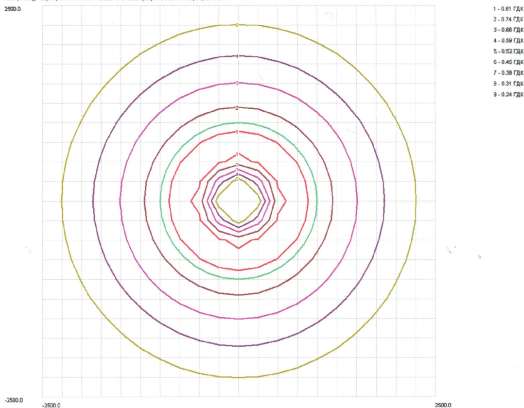
Рис. 4.6. Розрахункові дані розсіювання оксиду азоту по радіусу від джерела викидів за коефіцієнта \alpha = 1,0 надлишку повітря
