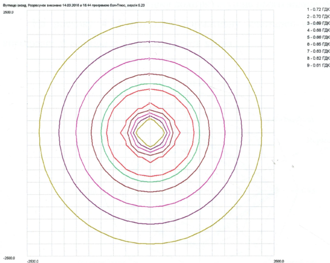
Рис. 4.13. Розрахункові дані розсіювання оксиду вуглецю по радіусу від джерела викидів за коефіцієнта \alpha = 1,6 надлишку повітря
