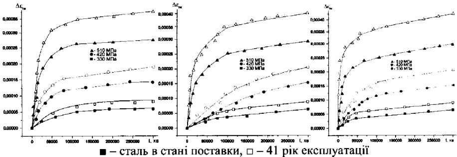
Рис. 11. Кінетика деформації сталі трубопроводу 19Г в кислих хлоридно-сульфатних середовищах МС10-12
