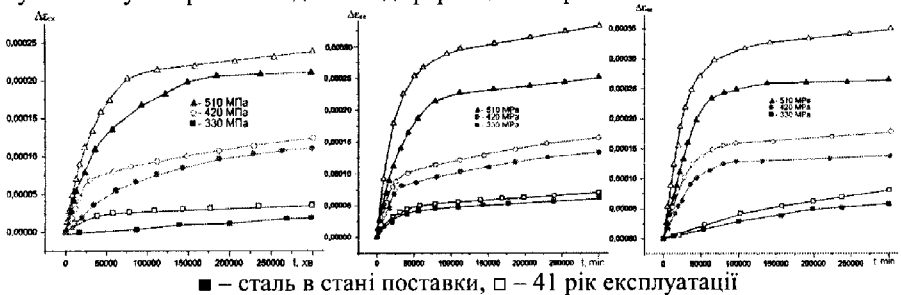
Рис. 4. Кінетика деформації сталі трубопроводу 17ГС в нейтральних хлоридних середовищах МС1-3
