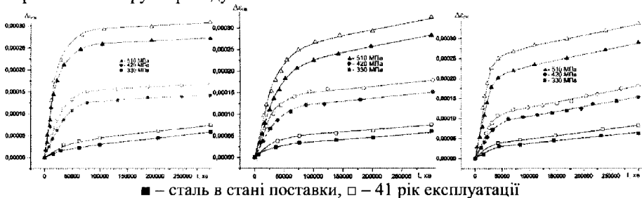
Рис. 5. Кінетика деформації сталі трубопроводу 17ГС в нейтральних хлоридно-сульфатних середовищах МС4-6
