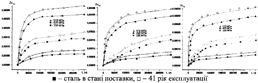
Рис. 9. Кінетика деформації сталі трубопроводу 17ГС в кислих хлоридно-сульфатних середовищах МС10-12
