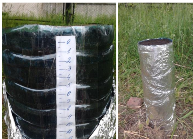
Рис. 1. Модельний дослід вертикальної міграції нафти у ґрунті
