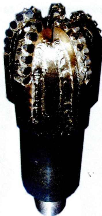
Рис 5.7. Бурове долото ІНМ-АП-165,1 С.
