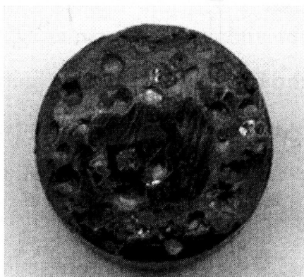
Рис. 4.3. Зображення робочої поверхні бурової вставки стандартного складу алмаз – твердий сплав ВК6 після випробування на зносостійкість, \times 24 .
