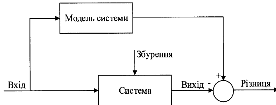
Рис. 1.3. Функціональна схема методу, що оснований на побудові моделі
