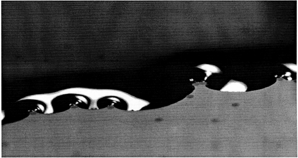
Рисунок 2.9 – Вплив гетерогенності поверхні твердого тіла на процес розтікання рідини
