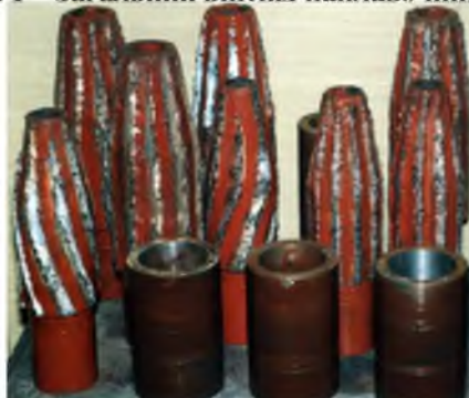
Рисунок 2 – Свердловинні конусні та кільцеві фрезери, наплавлені розробленим наплавочним матеріалом
