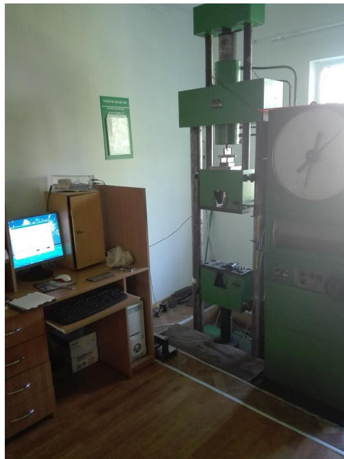
Рисунок 2.5 – Установка для визначення критичної тріщиностійкості металу бурильних труб
