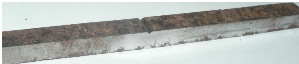
Рисунок 2.1 – Загальний вигляд зразка для дослідження умов спонтанного руйнування тривалоексплуатованої бурильної труби
