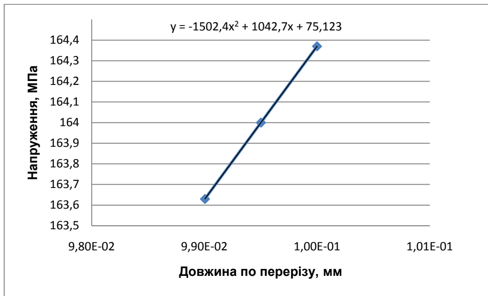
Рисунок 4.5 – Апроксимація результатів обчислень нормальних напружень у перерізі моделі
