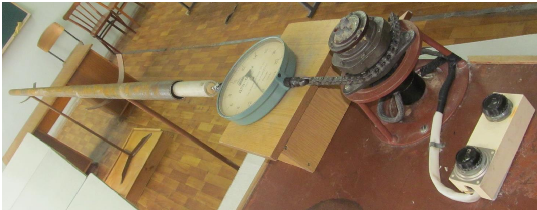
Рисунок 5 – Експериментальне визначення сили тертя між поліетиленовією трубою та сталевією
