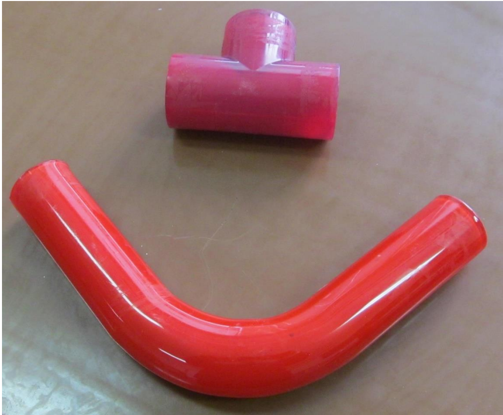
Рисунок 4.18 – Пофарбовані акриловою фарбою фасонні елементи трубопроводу
