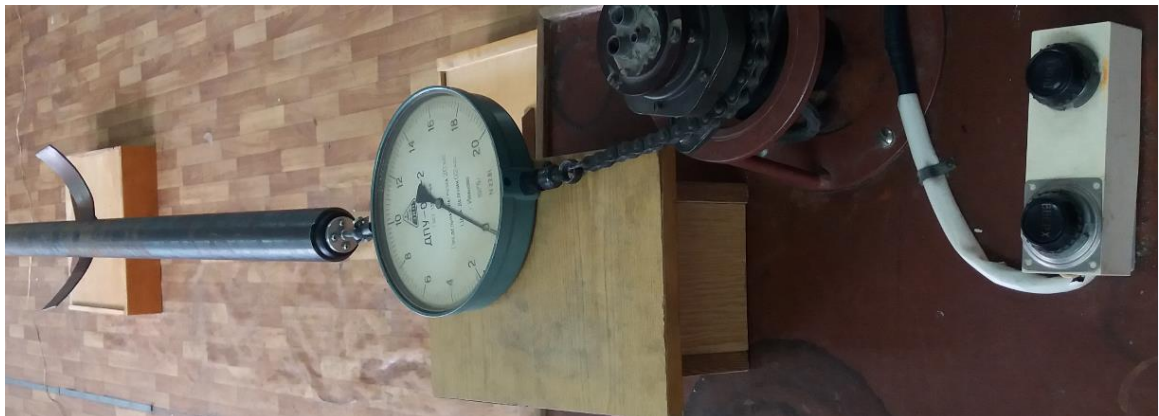
Рисунок 6.10 – Експериментальне визначення сили тертя між манжетами поршня та стінкою сталеві труби
