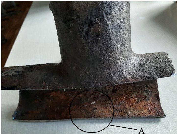
Рисунок 4.37 – Поздовжньо розрізаний трійник тепломережі з наскрізними дефектами
