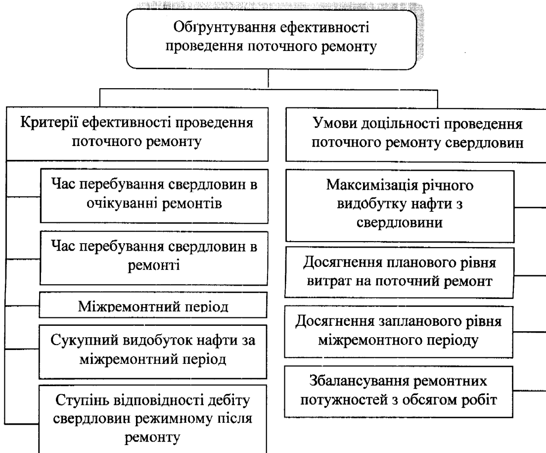
Рисунок 1.4 – Система показників ефективності проведення поточних ремонтів
