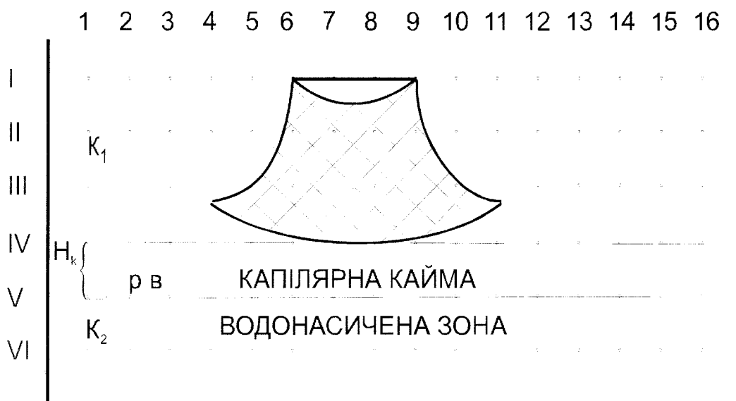
Рис. 2.9. Схема розповсюдження нафтопродуктів у неоднорідному ґрунті ( K_2 > K_1 ). Утримування капілярною каймою просування нафтопродуктів; H_k - висота капілярного підняття.
