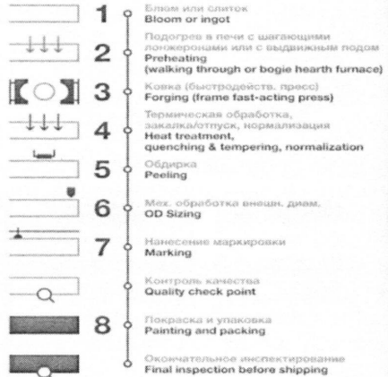
Рисунок 3 – Технологічний процес виготовлення злитка
