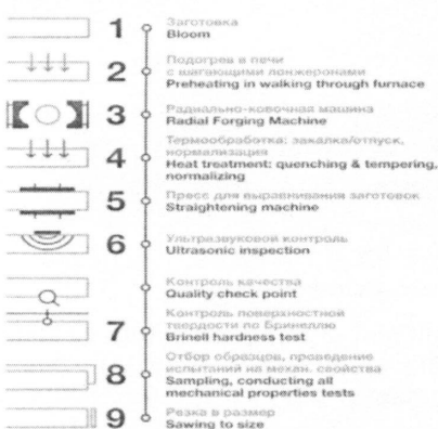
Рисунок 4 – Технологічний процес виготовлення блому
