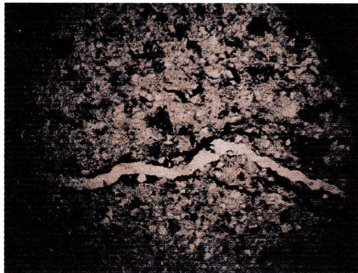
Рис. 4.6 - Шліф туфіту із тріщиною, по стінках якої спостерігались примазки нафти; розкриття тріщини 0,1мм ;менілітова світа, свердловина №14 Спас, глибина 2465-2466м.;  $\times 40$
