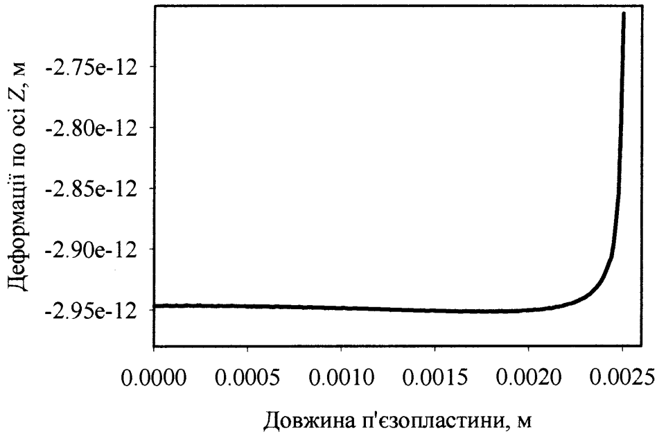
Рис. 3.6 – Деформація п'єзоелементу товщиною 1 мм, яка збуджена імпульсом на частоті 100 кГц на границі розділу середовищ із проміжним шаром
