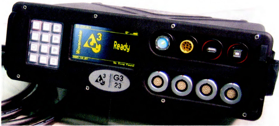
Рис. А.3 – Пристрій Wavemaker G3 для генерування та реєстрації спрямованих ультразвукових хвиль в стінці трубопроводу
