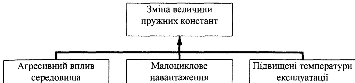
Рис. 4.10 – Деструктивні фактори, що призводять до зміни механічних властивостей сталі протягом тривалого часу експлуатації.
