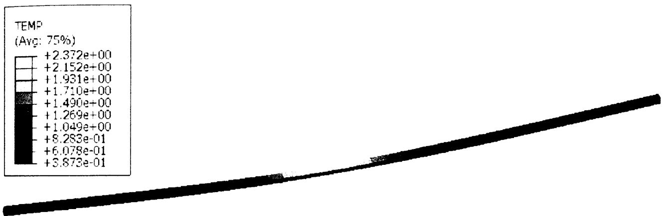
Рис. 5.9 – Розподіл температур від пластичних деформацій на зразку
