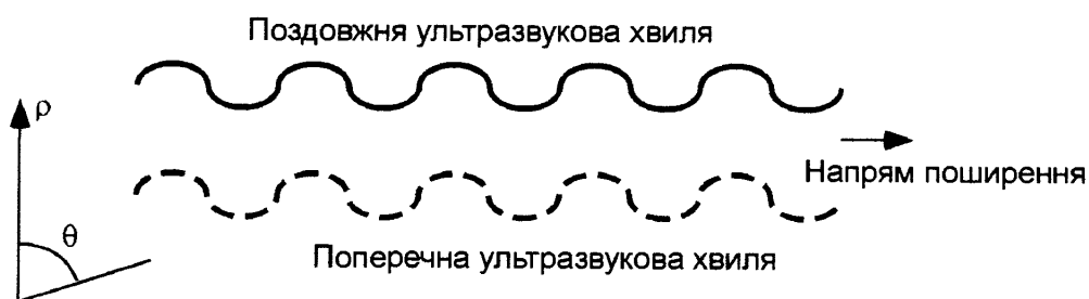
Рис. 2.5 – Утворення ультразвукової спрямованої кільцевої хвилі біжучими поздовжніми та поперечними хвилями.
