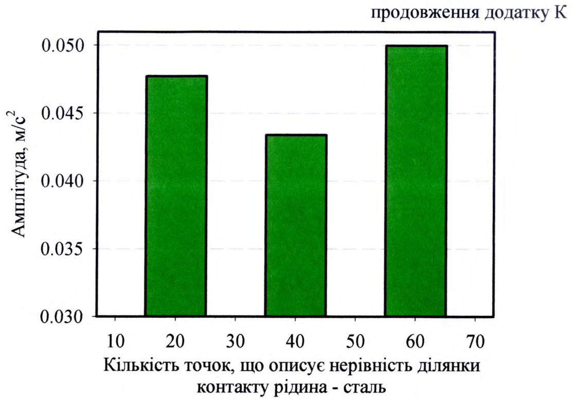
Рис. К.18 – Амплітуда ультразвукової хвилі при різних значеннях густини нерівностей
