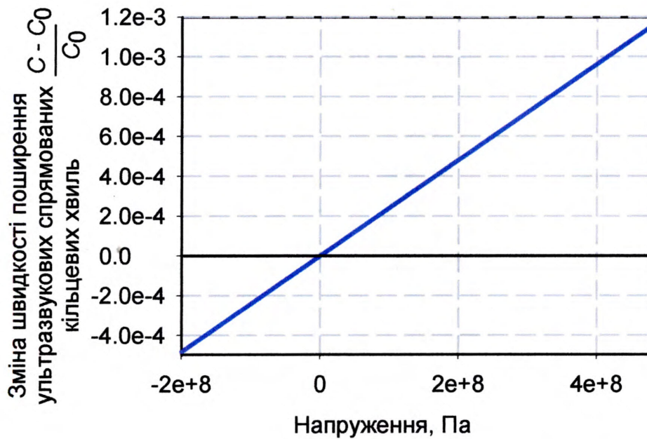
Рис. Д.8 – Акустопружність першої моди УСКХ частотою 2.5 МГц в стінці труби діаметром 273 мм, товщиною стінки 10 мм
