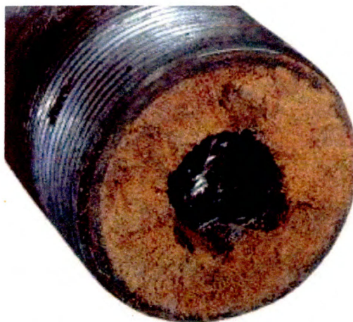
Рис. 1.2. Парафінові відкладення в НКТ
