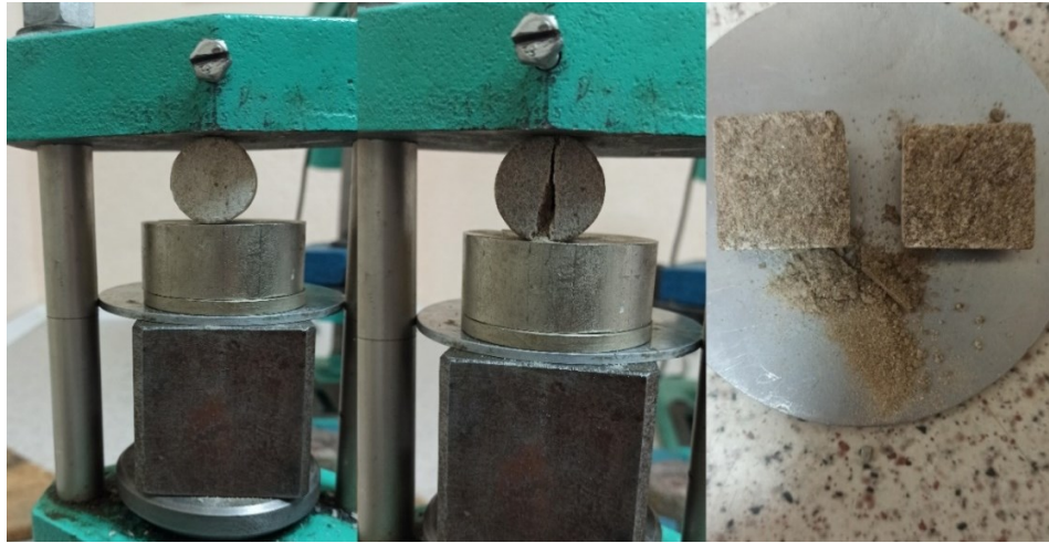
Рисунок 2.8 – Випробування зразків природного керну на міцність
