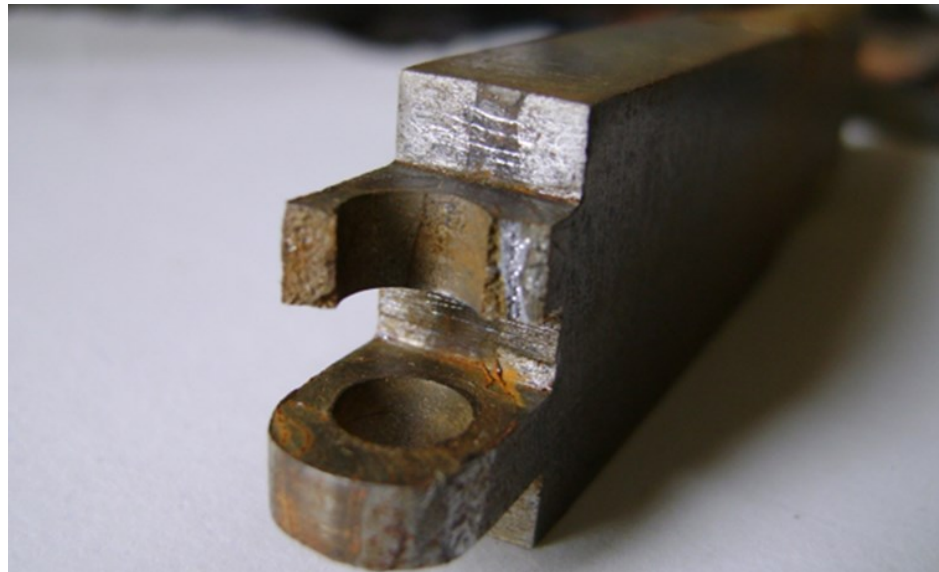
Рисунок 4.4 – Результат нераціональної експлуатації генератора ГКП (поломка перекидного клапану)
