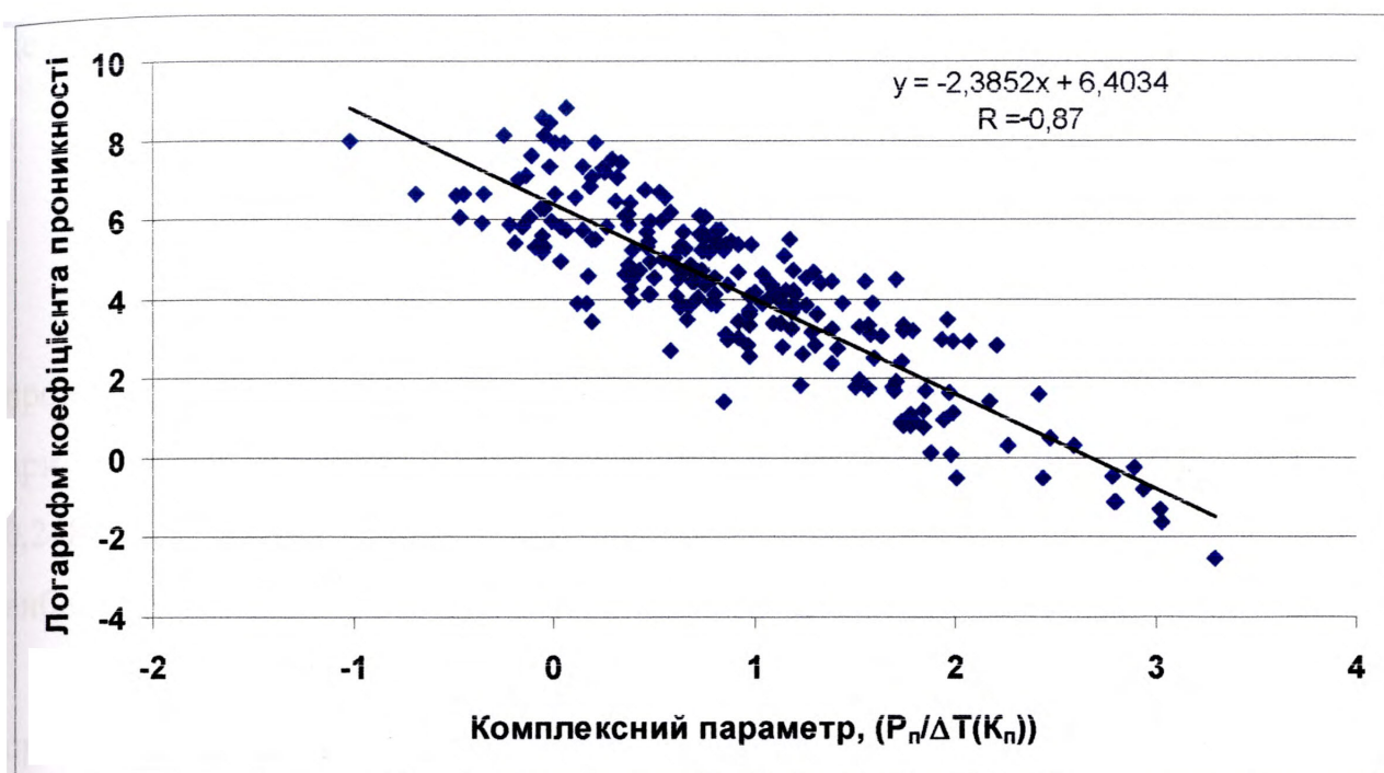
Рис. 2.7. Узагальнена залежність коефіцієнта проникності від комплексного геофізичного параметру для пісковиків родовищ ДДЗ.
