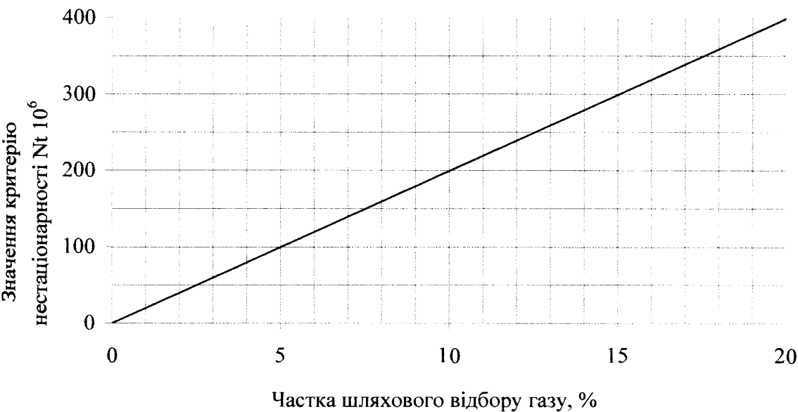
Рис. 2.14. Залежність критерія нестационарності від частки шляхового відбору газу із модельного газопроводу
