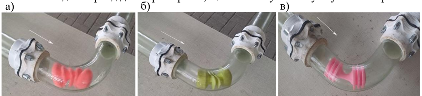
а) – манжетно-чашковий; б) – гантелеподібний-дводисковий; в) – гантелеподібний дисковий
