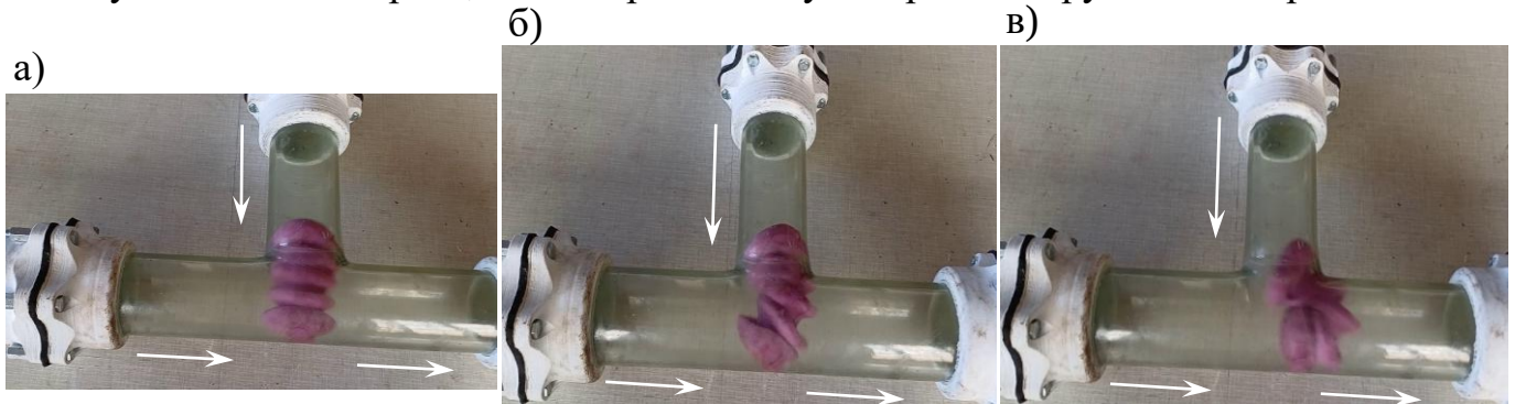
Рисунок 36 – Рух манжетно-чашкового поршня із силіконового компаунда трійником
