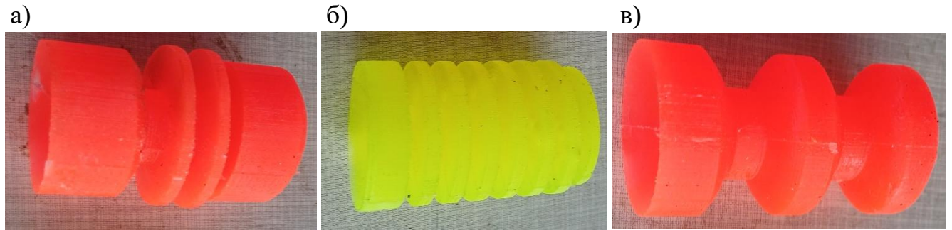
а) – циліндрично-дводисковий; б) – багатодисковий; в) – гантельно трикулевий Рисунок 17 – Дослідні зразки очисних поршнів із поліуретану
