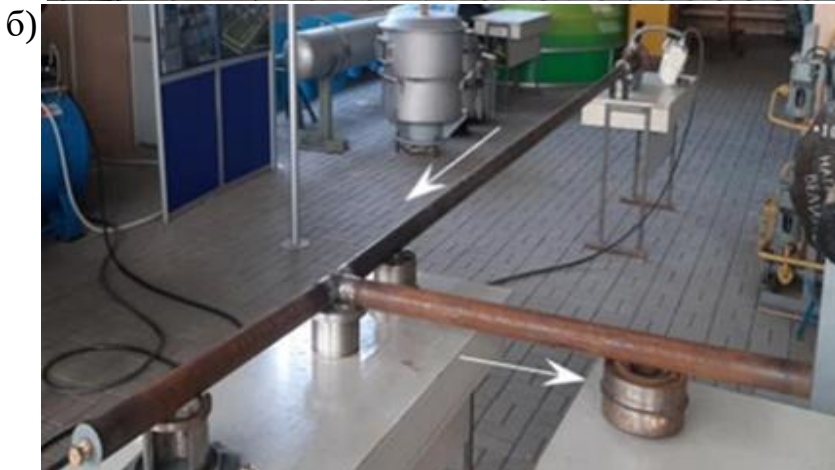
Рисунок 35 – Експериментальні установки для дослідження руху дослідних зразків поршнів трійниками трубопроводів
