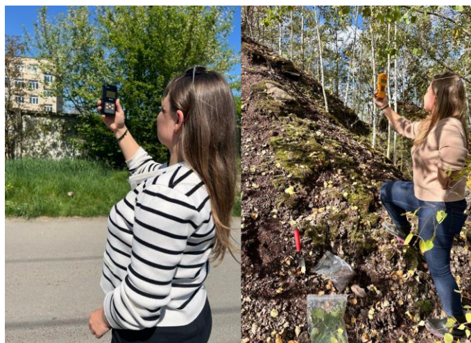
Рисунок 2.9 - Проведення вимірювання потужності еквівалентної дози \gamma -випромінювання поблизу терикону шахти «Межирічанська» та у межах прилеглих населених пунктів з метою порівняльного оцінювання радіаційного фону
