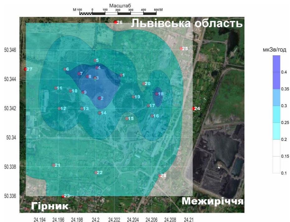
Рисунок 3.19 - Просторовий розподіл потужності еквівалентної дози гамма-випромінювання в районі терикону шахти «Межирічанська»
