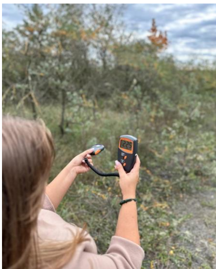
Рисунок 2.10 - Польові дослідження. Визначення інтенсивності світлового потоку на дослідній ділянці
