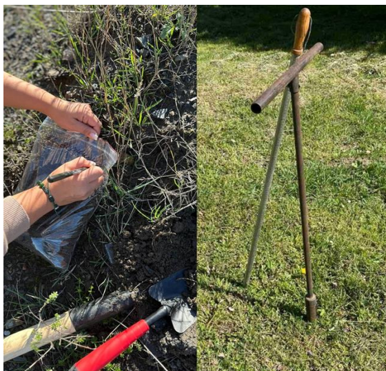
Рисунок 2.5 - Польові дослідження, відбір зразків ґрунтів у межах об'єкту дослідження за допомогою ручного пробовідбірника ґрунтів
