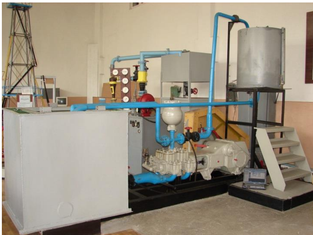
Рисунок 5.8 – Стенд для випробовування втулок циліндрових і штоків поршневого насоса двосторонньої дії
