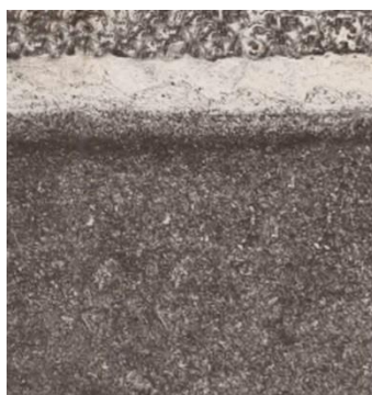
Рисунок 4.27 – Фото «білого шару» на сталі 40Х (х200), сформованого фрикційно-зміцнюючою обробкою
