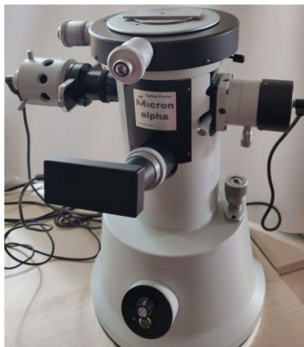
Рисунок 3.8 – Безконтактний інтерференційний 3D-профілометр «Micron-alpha»
