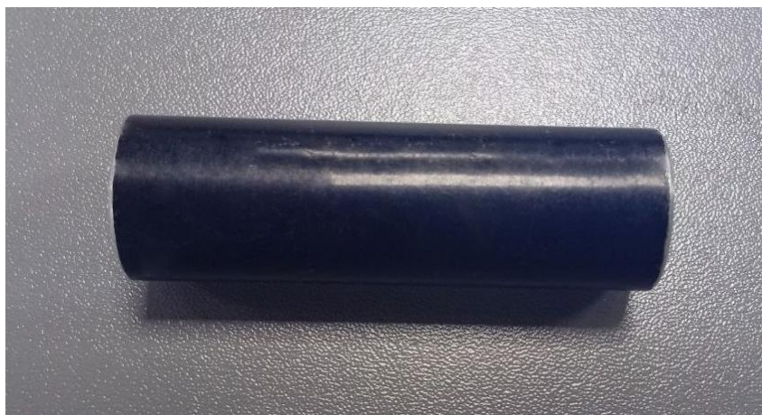
Рисунок 5.11 – Захисна втулка вала відцентрового насоса
