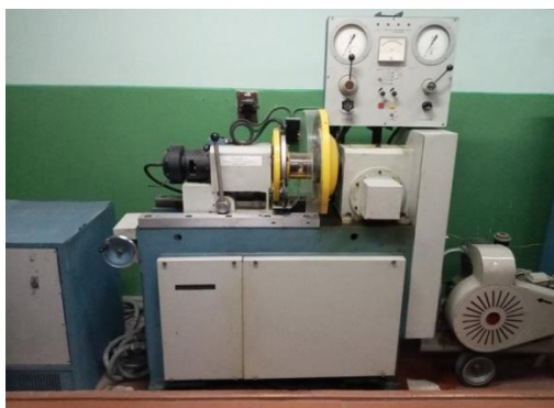
Рисунок 3.5 – Фотографія машини для випробовування матеріалів на тертя 2168 УМТ
