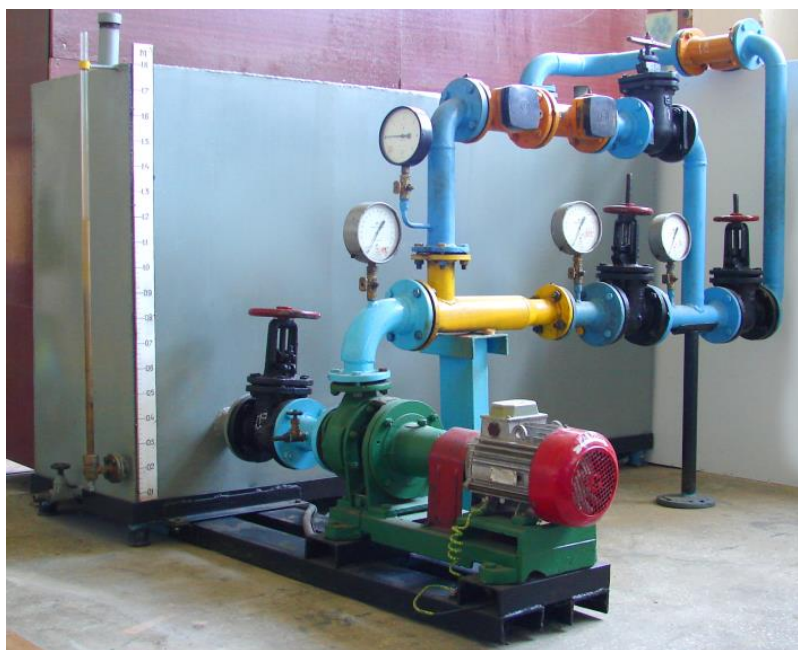
Рисунок 5.7 – Стенд для випробовування захисних втулок вала відцентрового насоса
