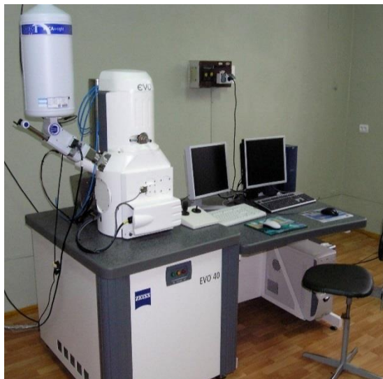
Рисунок 3.11 – Фотографія скануючого електронного мікроскопа ZEISS EVO 40XVP
