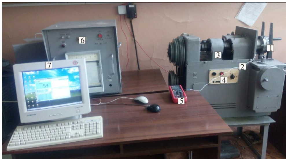
1 – торцеве ущільнення; 2 – термopapa; 3 – індукційний датчик моменту тертя; 4 – обертач машини СМЦ-2; 5 – мультиметр UT-78B з аналогово- цифровим перетворювачем; 6 – блок управління машини СМЦ-2; 7 – персональний комп'ютер
