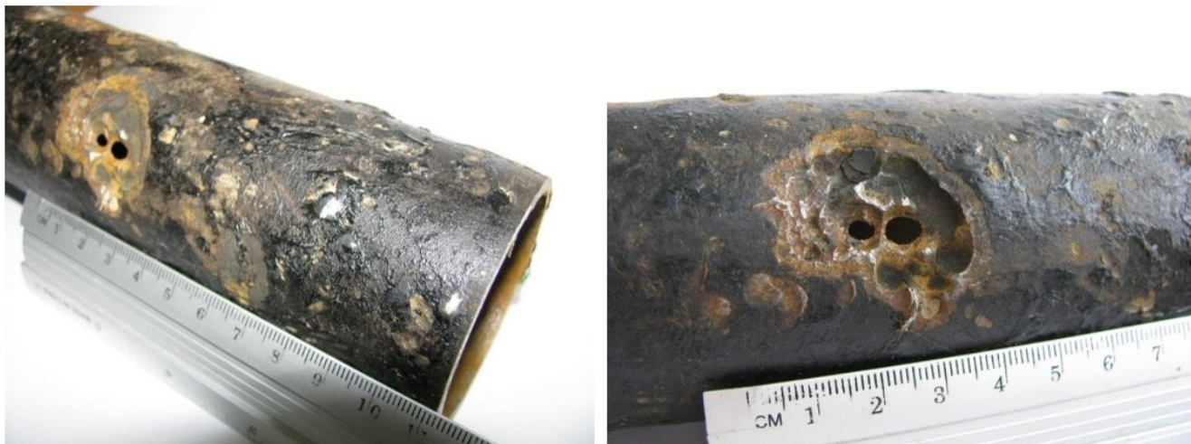
Рисунок 1.3 – Фрагменти сталюї труби підземного газопроводу низького тиску з характерними ознаками електрокорозійного пошкодження вирізаний в місці аварійного витоку природного газу [32]
