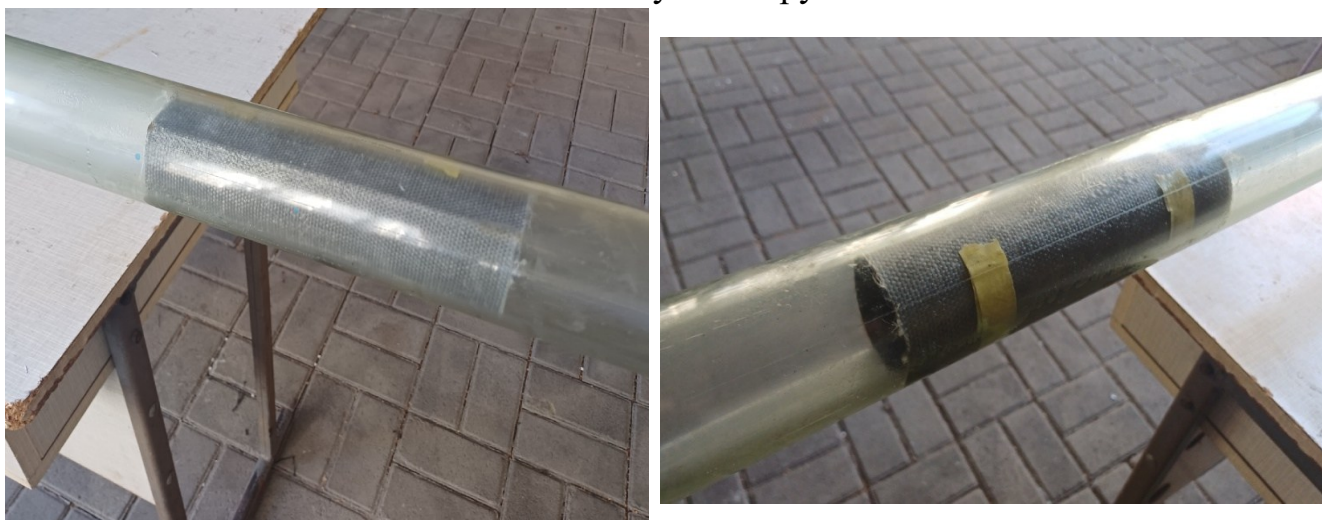
Рисунок 4.9 – Внутрішньотрубно встановлений ремонтний бандаж
