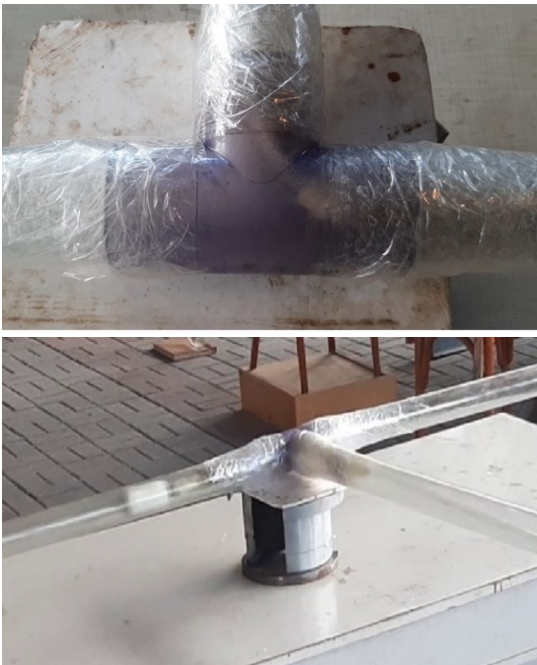
Рисунок 3.13 – Протягування поршнем з осьовим отвором ремонтної системи трубопроводом, який містить прозорий пластиковий трійник
