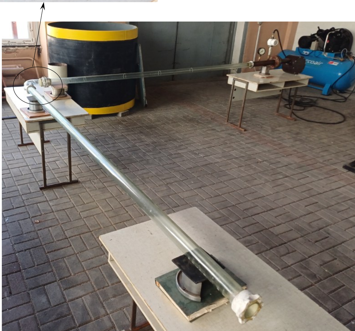
Рисунок 3.7 – Експериментальна установка для дослідження динаміки протягування байпасним поршнем ремонтної системи трубопроводом, який містить коліно
