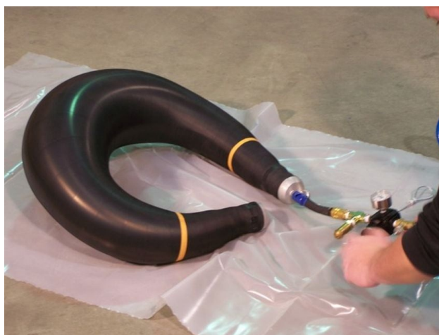
Рисунок 1.14 – Пакер для відводів трубопроводів [68]
