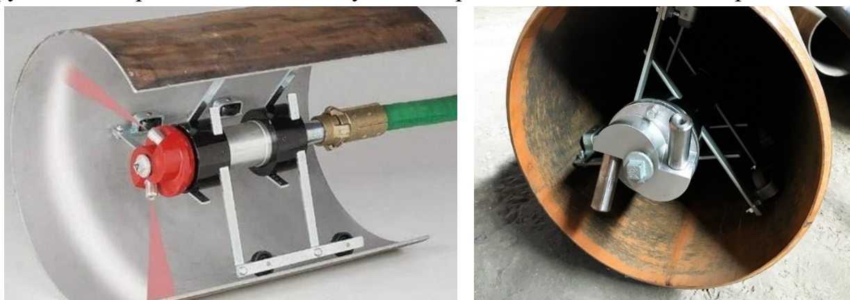
Рисунок 1.4 – Пристрої для струменевого внутрішньотрубного очищення трубопроводів [45]
