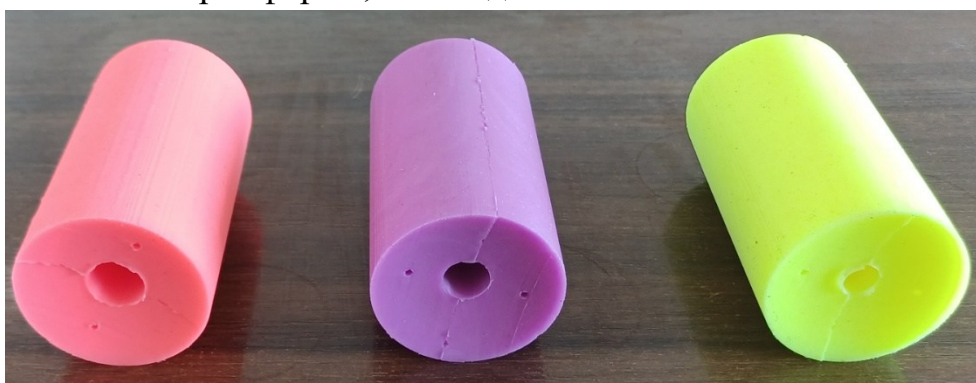
Рисунок 3.4 – Виготовлені поршні із осевим отвором з силіконового компаунда
