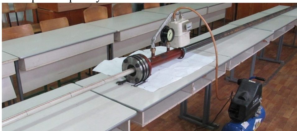
Рисунок 1.20 – Експериментальне протягування поліетиленової труби очисним поршнем в зношений сталевий трубопровід
