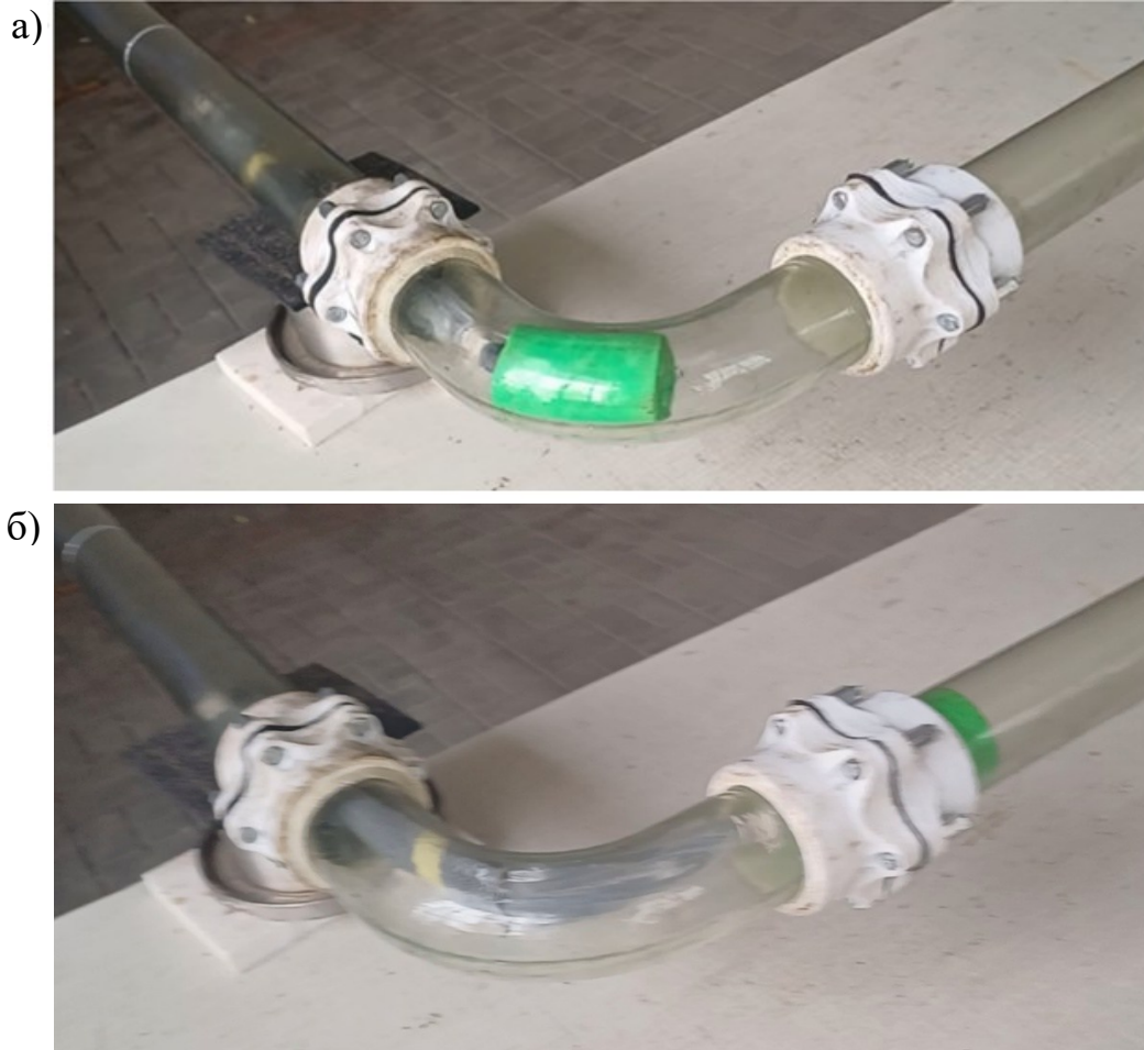
а) – рух поршня середньою частиною відводу; б) – протягування ремонтної системи відводом
