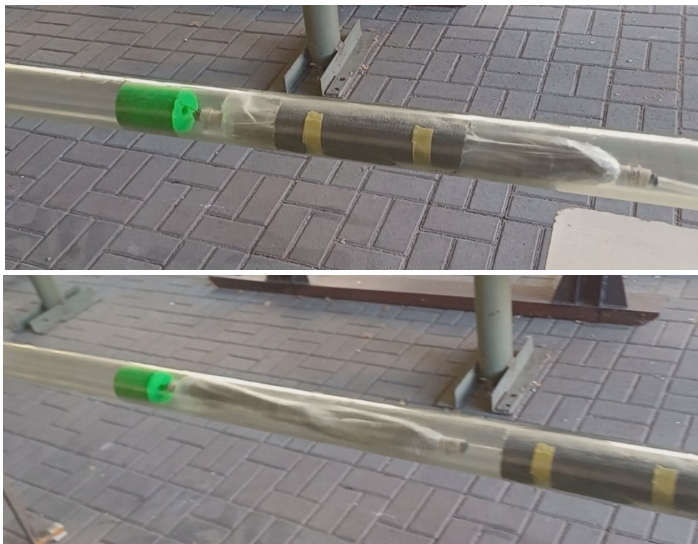
а) – деаерована еластична оболонка; б) – протягування байпасним поршнем еластичної оболонки та гнучкої трубки
