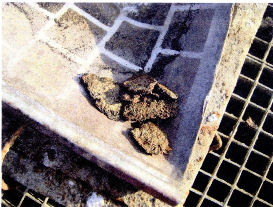
Рисунок 4.9 – Шматки іржі і частинки породи з забруднювачами, винесені зі свердловини під час роботи генератора ГКП-56 при тиску в нагнітальній лінії 7 МПа
