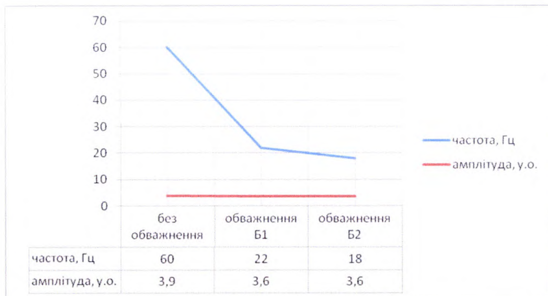
Рисунок 3.18 – Залежність частоти та амплітуди від обважнення кривошипа для клапану довжиною 100%.
