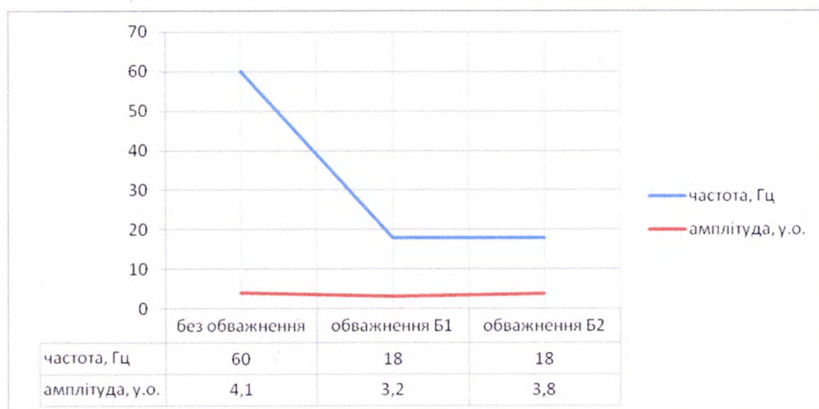
Рисунок 3.19 – Залежність частоти та амплітуди від обважнення кривошипа для клапану довжиною 80%.
