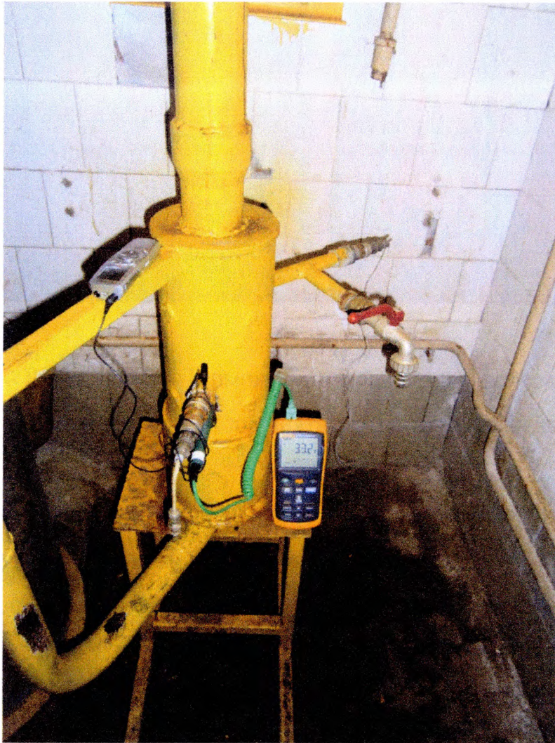
Рисунок 3.2 – Вимірювання процесу поширення температури та акустичних хвиль удосконаленого гідравлічного генератора імпульсно-хвильової дії за допомогою термометра FLUKE 54 II, пьезомікрофона AKG-164 та диктофона OLYMPUS VN-480PC
