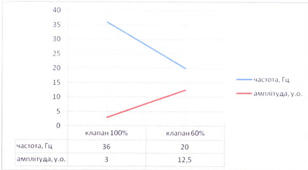
Рисунок 3.15 – Залежність частоти та амплітуди від довжини клапану для генератора ГКП-56 без обважнення.
