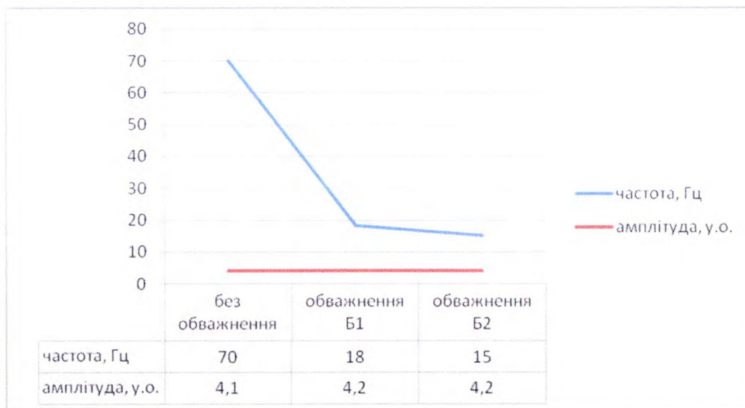
Рисунок 3.20 – Залежність частоти та амплітуди від обважнення кривошипа для клапану довжиною 70%.
