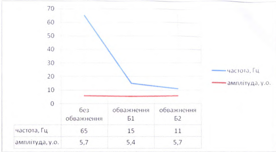
Рисунок 3.22 – Залежність частоти та амплітуди від обважнення кривошипа для клапану довжиною 50%.
